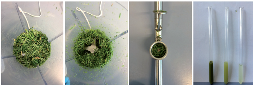
Abb. 1: Ablauf der Saftgewinnung aus Tannennadeln (A: Nadeln vor dem Mixen; B: Nadeln nach dem Mixen; C: Saftgewinnung aus der Knoblauchpresse; D: gepresster Saft der Tanne)
