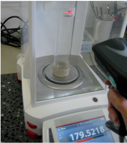
Abb. 6: Einwaage der auf den Fettgehalt zu untersuchenden Futterprobe in ein Hydrolysegefäß
