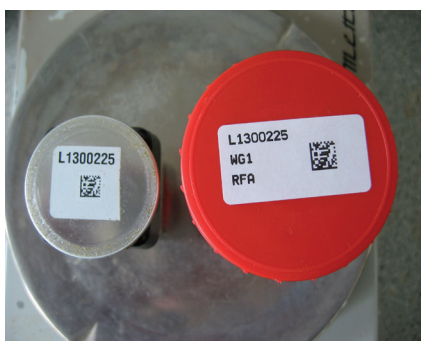
Abb. 4: Barcodes auf Probengefäß und Probenpressling für die automatisierte RFA
