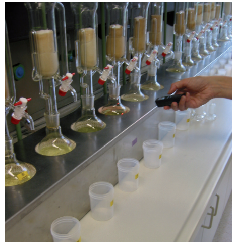
Abb. 7: Einscannen der Barcodes von Patrone und Glaskolben Mittels Mobil-Scanner
