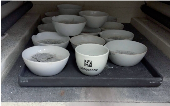
Abb. 3: Tiegel im Muffelofen mit QR-Code und Gefäßnummer
